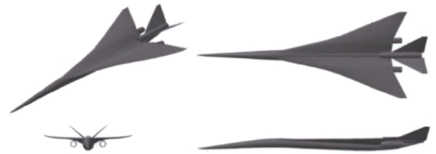
图1 LM1021 标准模型 [18] Fig.1 LM1021 standard model [18]
